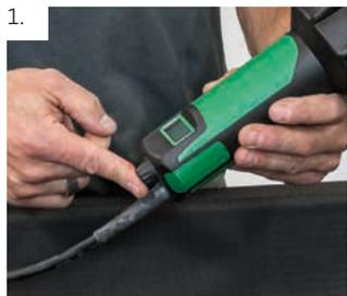
Schweißtemperatur zwischen ca. 500 °C (Stufe 8) und maximal 700 °C (Stufe 10) wählen. Die optimale Einstellung ist abhängig von der Umgebungstemperatur, den Witterungsverhältnissen und der Untergrundbeschaffenheit.
