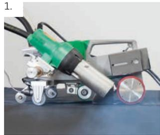
Bitte stellen Sie die Schweißtemperatur auf ca. 620 °C (höchste Stufe) ein. Die Einstellung der Luftzufuhr ist witterungsabhängig. Die Andrückrolle des Schweißautomaten genau entlang des oberen Bahnenrandes führen.
