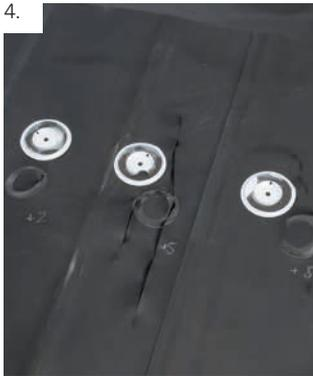
Geräteeinstellung (Kalibrierung) auf die Witterungs- und Umgebungsbedingungen mittels einer Reihe von Probeverschweißungen vornehmen.
