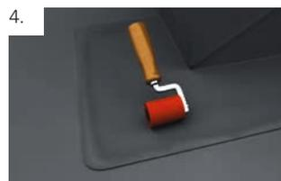
Danach wird die Naht mit einer Silicon-Andrückrolle in Längs- und Breitenrichtung angerollt. Hierbei ist auf eine austretende Kleberaupe zu achten.
