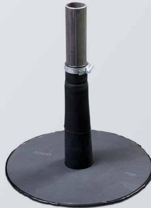
EPDM-Formteil zur Eindichtung von überstülpbaren Dachdurchdringungen mit rundem Querschnitt und mit Durchmesser von 35 bis 50 mm. Der Anschlusskragen besteht aus einem kreisförmigen Zuschnitt aus RESITRIX® SK W Full Bond mit einem Durchmesser von bis zu 30 cm.
