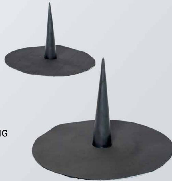
EPDM-Formteil zur Eindichtung von überstülpbaren Dachdurchdringungen mit rundem Querschnitt und mit Durchmesser von 5 bis 35 mm. Der Anschlusskragen besteht aus einem kreisförmigen Zuschnitt aus RESITRIX® SK W Full Bond mit einem Durchmesser von bis zu 30 cm.
