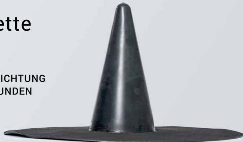
EPDM-Formteil zur Eindichtung von überstülpbaren Dachdurchführungen mit rundem Querschnitt und mit Durchmesser von 35 bis 100 mm. Der Anschlusskragen besteht aus einem kreisförmigen Zuschnitt aus RESITRIX® SK W Full Bond mit einem Durchmesser von 50 cm.
