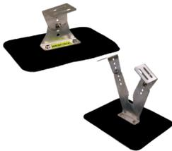
Zur Befestigung von Photovoltaikanlagen und weiteren Aufbauten mit werkseitiger RESITRIX® Anschluss-Manschette. Der Halter besteht aus gelenkigen Oberteilen und ist somit in der Höhe sowie auch in der Modulneigung flexibel. Einstellbar von 120 - 180 mm (tief) bzw. 240 - 300mm (hoch).
